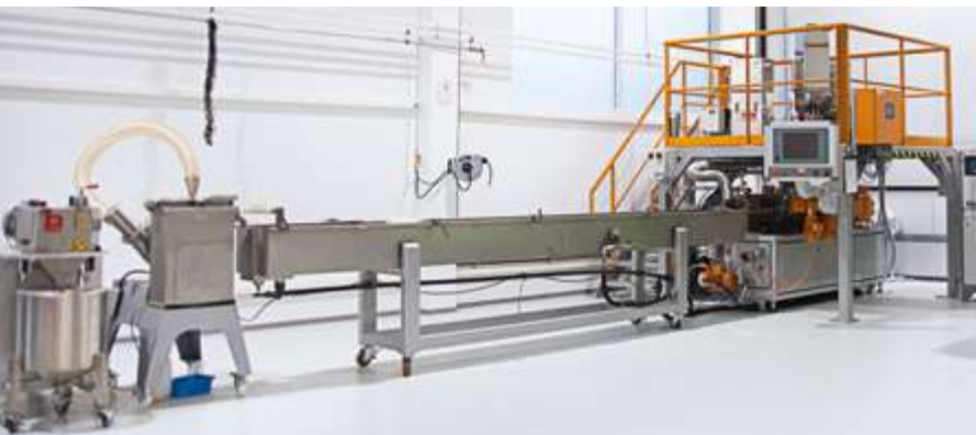
Twin-screw extruder with strand granulator Doppelschneckenextruder mit Stranggranullierung
